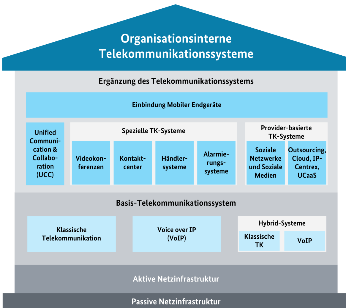
Abbildung: Organisationsinterne Telekommunikationssysteme
