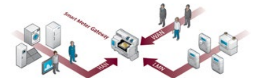
Das Smart Meter Gateway als Kommunikationseinheit in einem intelligenten Messsystem und als zentrale Komponente zwischen Weitverkehrsnetz (WAN), Lokalen Metrologischen Netz (LMN) und dem Heimnetz (HAN)
