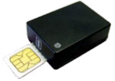
Die GSM-Wanze bietet auf kleinstem Raum die Funktionalität eines Mobiltelefons, um Raumgespräche abzuhören.
