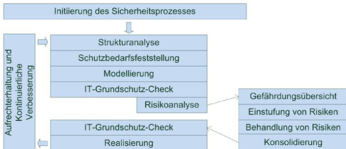
Abb. 2.4: Integration der Risikoanalyse in den IT-Grundschutz-Prozess (aus [BSI16e])
