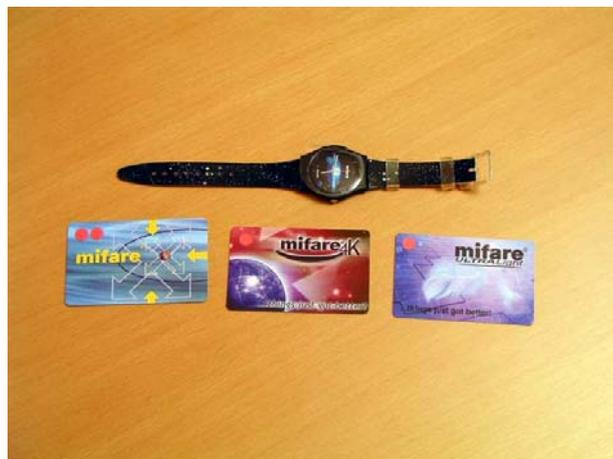
Abbildung A2: Tags: Armbanduhr (oben), Karte "Doppelpunkt", Karte 4k, Karte Ultra Light (von rechts nach links)
