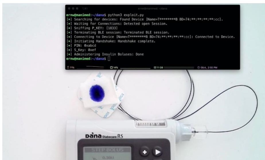
Abbildung 12: Die Insulinpumpe DANA Diabecare RS, nachdem ein Angreifer die BLE-Sitzung übernommen und mehrere Insulinboli verabreicht hat (veranschaulicht durch blaue Tinte). (Quelle: ERNW)
