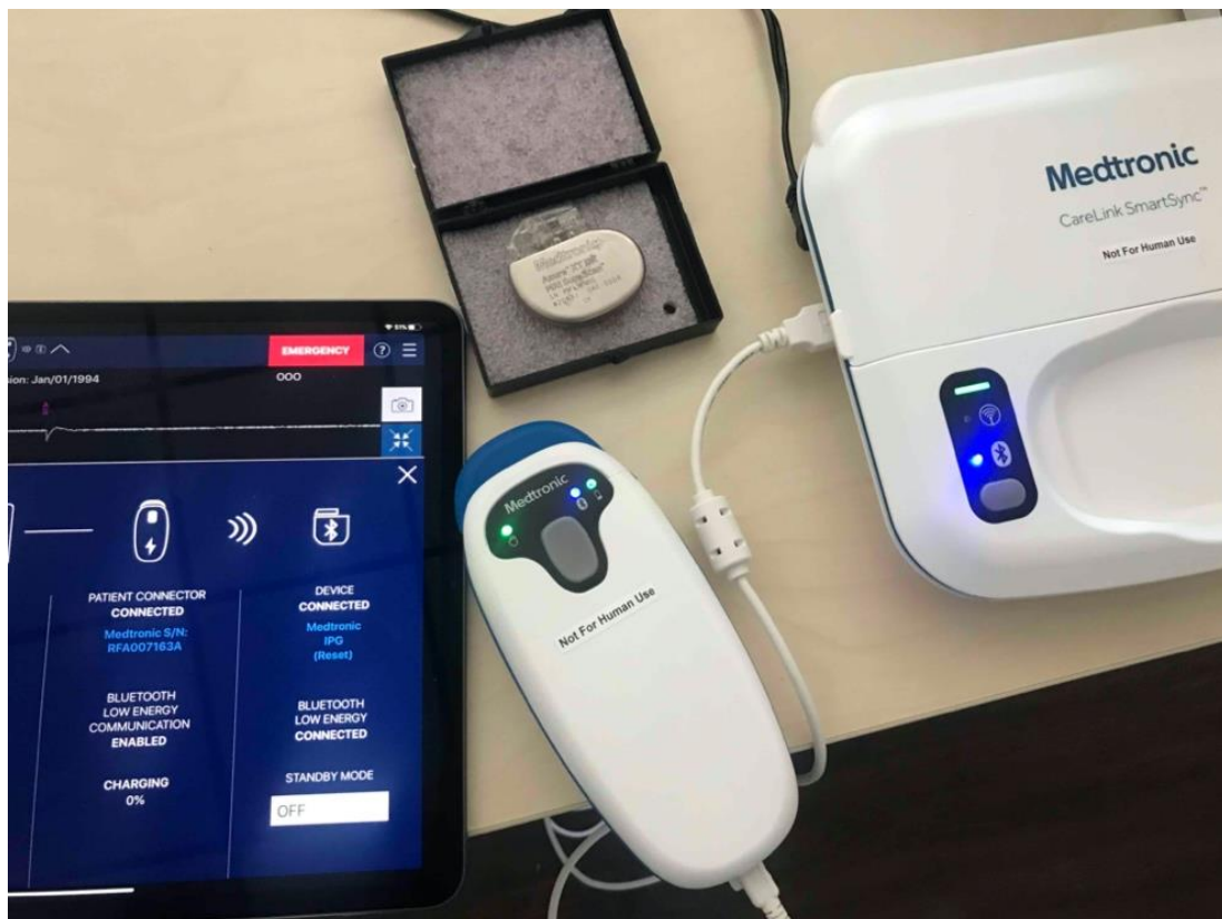
Abbildung 11: Das Testlabor des Medtronic CareLink SmartSync Device Manager-Systems, bestehend aus der Basiseinheit (rechts), einem Handheld (unten Mitte) und einem iPad mit der App (links) sowie einem Herzschrittmacher (oben Mitte). (Quelle: BSI)
